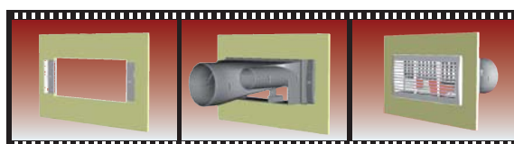
Découpe de la cloison et insertion des pinces
