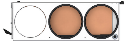
Plénum soufflage 2 x Ø 200 mm
